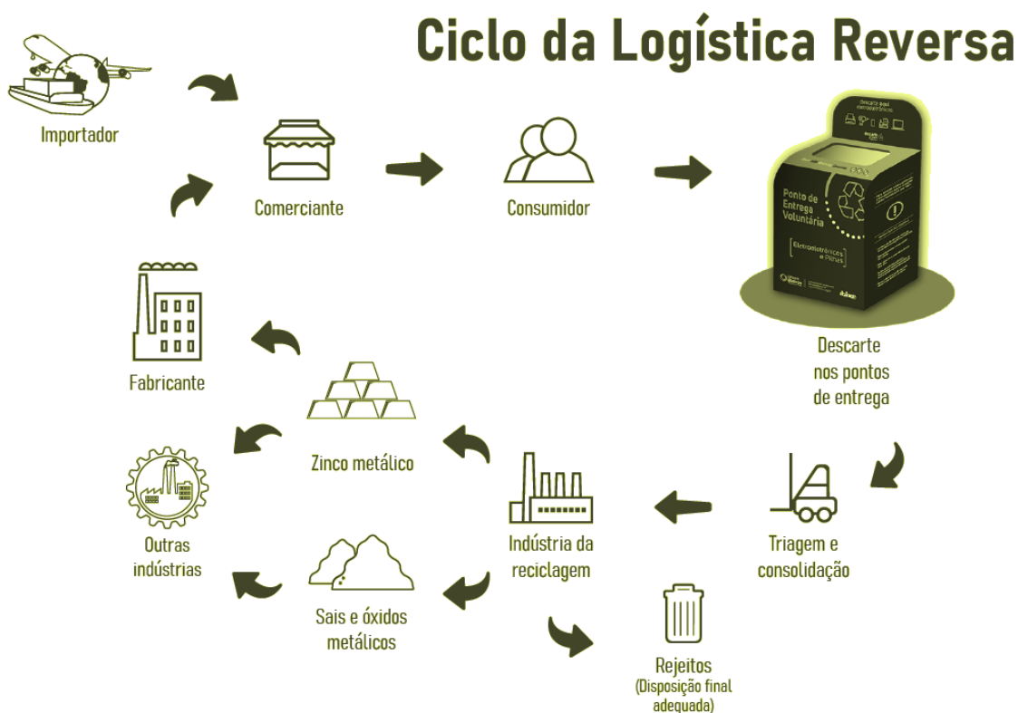
Figura 78: Ciclo da Logística Reversa de Pilhas e Baterias.
