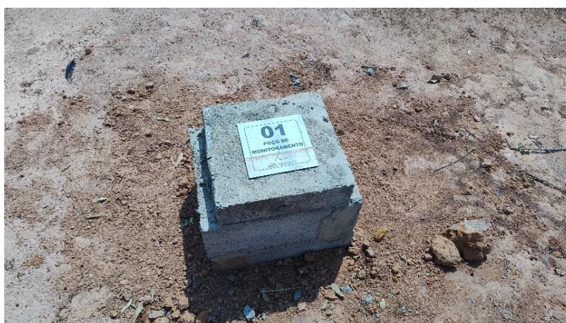
Figura 85: Poço de monitoramento.
